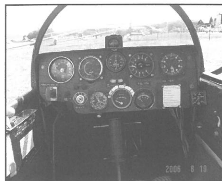
A HB 3 típusú motoros vitorlázógép műszerfala
